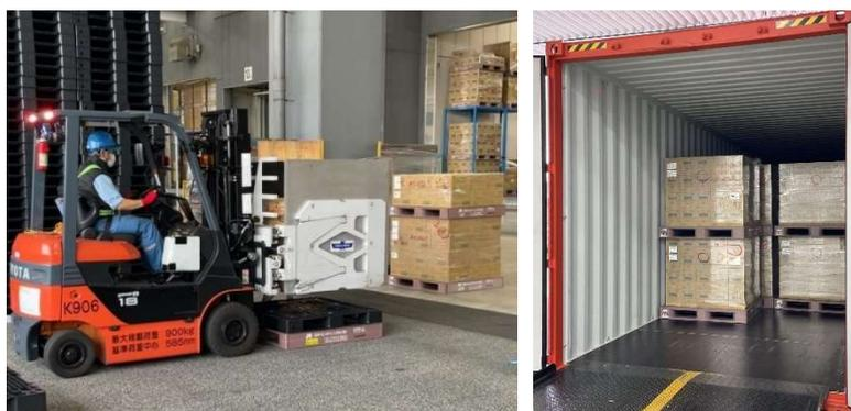
日本から中国へ輸出するファイントゥデイ製品。従来は海外用使い捨てパレットへの積み替えが必要だったが（左図・黒のパレット）、本件スキームは国内用レンタルパレットをそのまま使用して輸出（右図）
